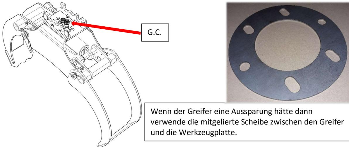
Der weibliche Hydraulikverschluss der Schnellkopplungen wird an den bestehenden Hydraulikschläuchen der Greifer befestigt. Wenn die Werkzeugplatte montiert wird beobachte dann das die Schlauch für Greifer schließen (G.C.) sich bei die Buckel für die Aussparung befindet.
